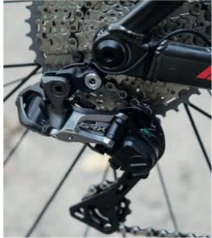
Elektronisches Schaltwerk der SHIMANO GRX-Schaltung fürs Gravelbike.
