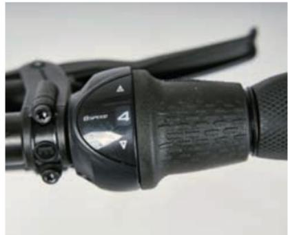
Häufig werden diese mit praktischen Drehschaltgriffen kombiniert.
