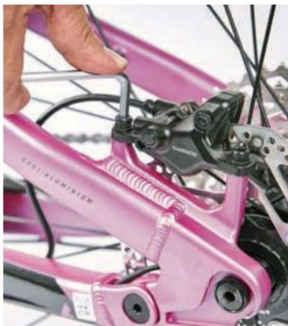
Wenn Bremsbeläge schleifen und quietschen, kann es sein, dass diese nicht exakt parallel zur Bremsscheibe sitzen; dann kann der Bremsattel dezent nachjustiert werden.
