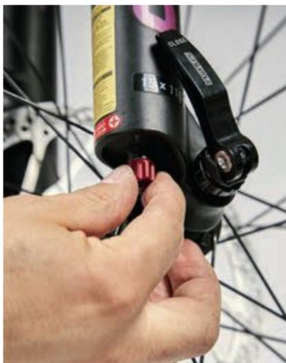
Das Drehrädchen an der Unterseite der Federgabel regelt meist die Zugstufe – also die Ausfeder-geschwindigkeit.
