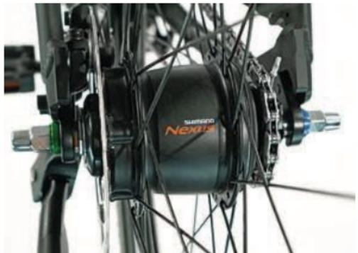
Schraubachse an einer Nabenschaltung.
